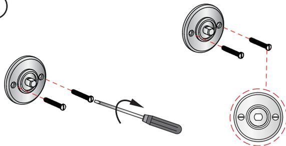
Прикрутите основы болтами к стене. Убедитесь, что головки болтов расположены параллельно полу.
