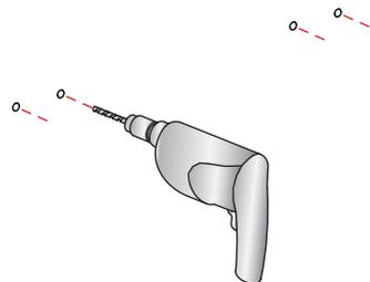
При помощи 6мм сверла просверлите отверстия в отмеченных карандашом точках.
