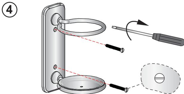
4 Прикрутите основу болтами к стене. Убедитесь, что головки болтов расположены параллельно полу.
