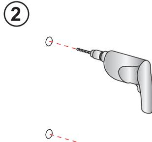
2 При помощи 6мм сверла просверлите отверстия в отмеченных карандашом точках.
