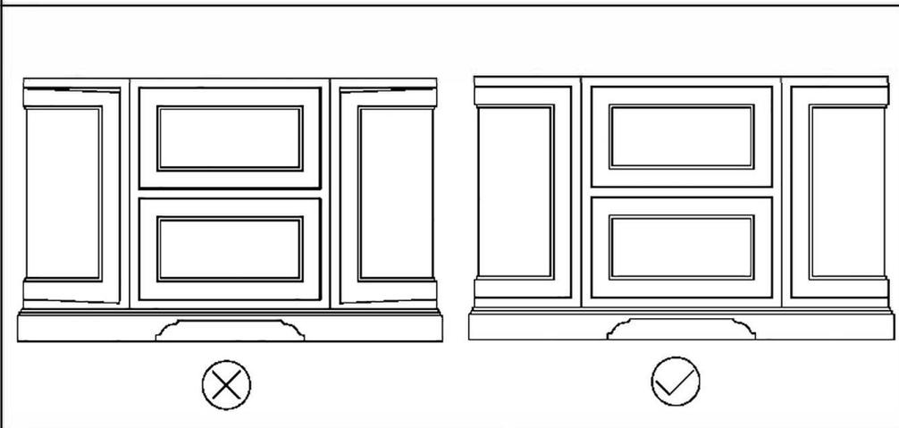
• Проверьте уровень дверцы и ящика. Для регулировки прокрутите винт в петле или в направляющей.
