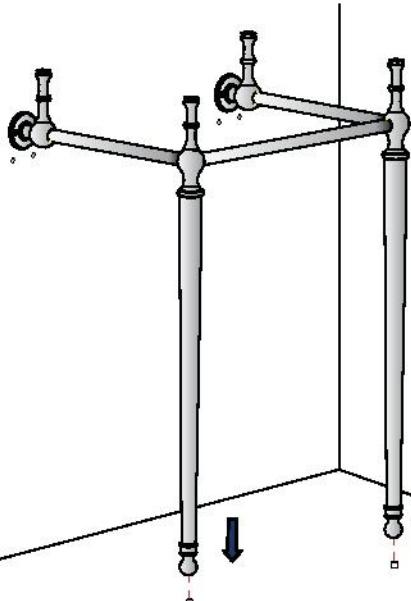
**8** Используя 4 входящие в комплект поставки винта, закрепите к стене два кронштейна. Убедитесь, что головки винтов параллельны полу.
