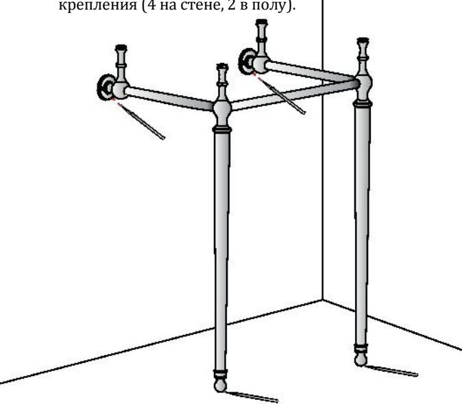
**6** При помощи сверла диаметром 6мм просверлите шесть отверстий в отмеченных карандашом местах (в случае, если входящие в комплект поставки настенные/напольные крепления не подходят, используйте альтернативные крепления).
